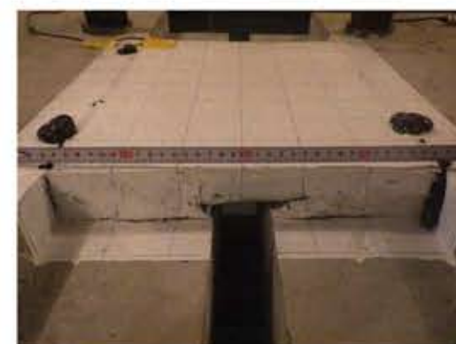
最大引張状態 (-20 mm) 側面状態
