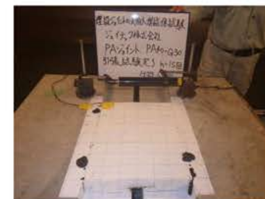
引張試験完了 (n=15回)
