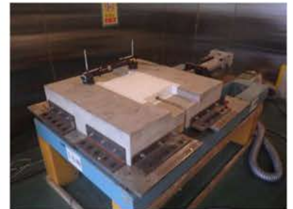
変位計の設置およびメッシュ描き（50 mmピッチ）
