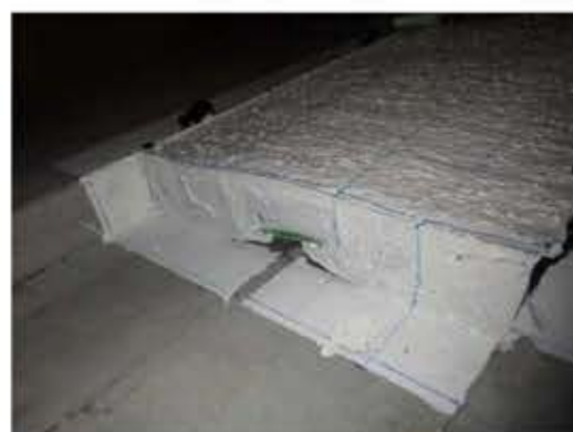
最大圧縮状態 (+20 mm) 側面状態
