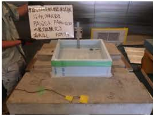
24 時間後、漏水なし
