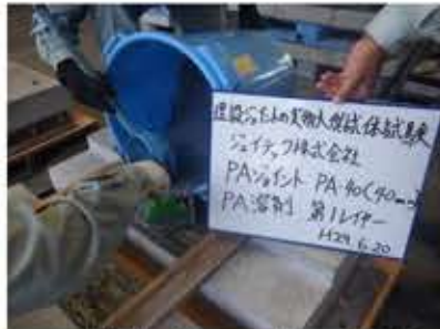
PA溶剤、第1レイヤー流込み
