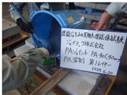
PA溶剤、第1レイヤー流込み
