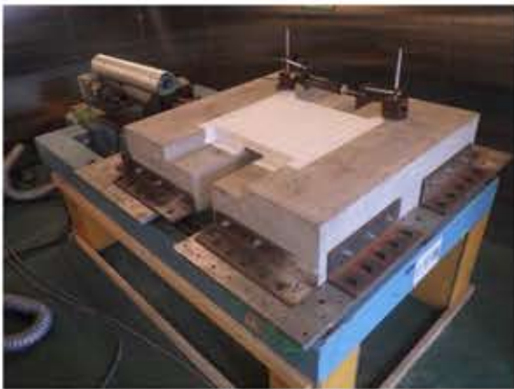
変位計の設置およびメッシュ描き（50 mmピッチ）
